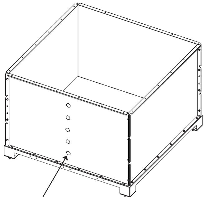
**NB .:** Vorstanzung in diversen Höhen für die Montage von Pellet-Füllstandssensoren Art. Nr.: EN4210.00.01
