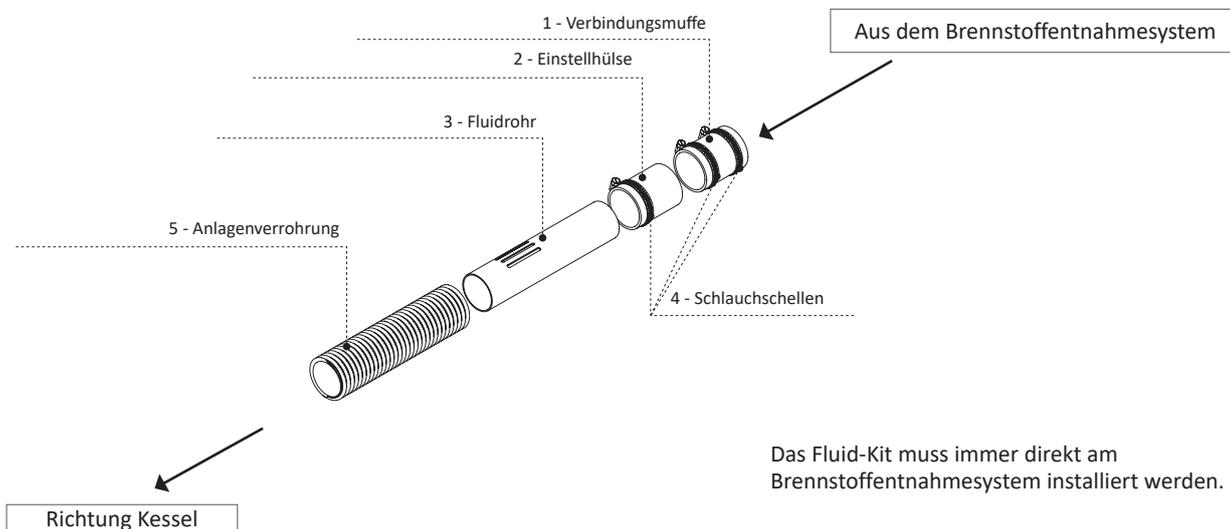
Das Fluid-Kit muss immer direkt am Brennstoffentnahmesystem installiert werden.
