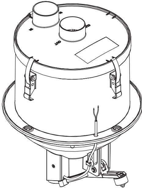
**Schallabsorber für Dosierzyklon**
