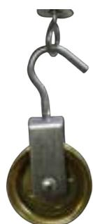
Hänge die beiden Flaschenzüge mit geschlossenen Ösen an die beiden Dübel.
