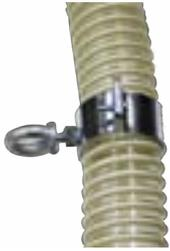
Befestigen Sie die beiden Rohrschellen mit Ösenschrauben am Saugschlauch, die erste in einem Abstand von ca. 80 cm von dem Spider und die zweite in einem Abstand von ca. 180 cm.
