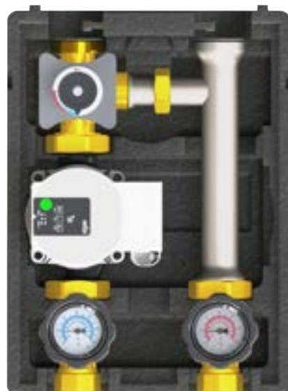
**ENVIRON THERMOREFLUX X, kompakte Rücklaufanhebung / Ladeventileinheit DN25 mit Drei-Wege-Mischer und ELODRIVE STM 20-80°C Stellmotor.**
