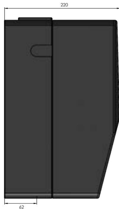
Die Pumpengruppe THERMOREFLUX X ist eine Montagefertige, kompakte Rücklaufanhebung / Ladeventileinheit zur Hochhaltung der Kessel- und Rücklauftemperatur für alle gängigen Kesselgrößen von 5kW bis 80 kW Nennleistung. Elektronisch geregelt mit eingebauten Drei-Wege-Mischer aus Messing. Sie können zwischen einem ELODRIVE ST 10 und einem ELODRIVE STM elektrischem Stellmotor auswählen.
