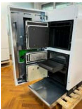
Zwei große Aschekästen erleichtern die Reinigung des Kessels. Die Brennkammer benötigt etwa nach jedem Verbrauch von 1500 kg Holz eine Reinigung.
