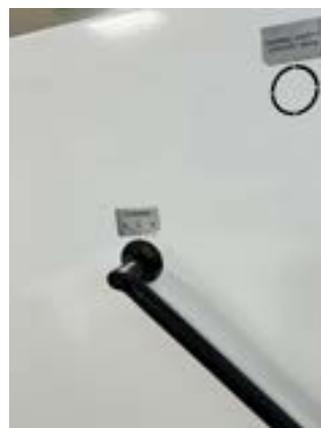
Hebel für die Bewegung der Turbulatoren und die Reinigung des Wärmetauschers.
