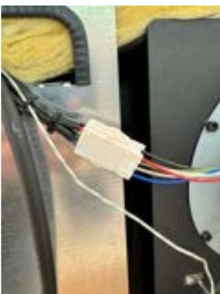
Das Abgasgebläse kann für eine erleichterte Reinigung mühelos elektrisch entkoppelt werden, dank praktischer Steckverbindungen.
