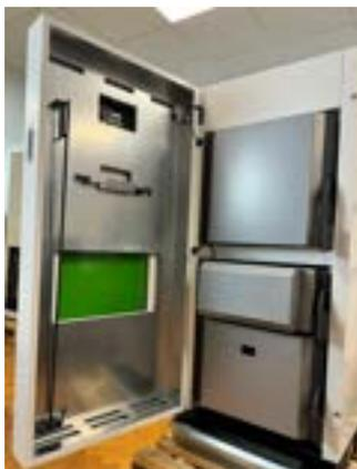
Geöffnete Fronttür mit integriertem Display, Ablage und Hängevorrichtung für Reinigungswerkzeug.
