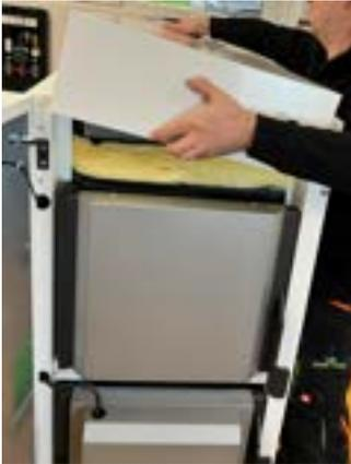
Für den Transport lässt sich der Pyromax Pro vollständig demontieren, indem die gesamte Verkleidung abgenommen wird.
