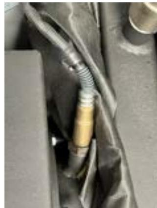
Lambdasonde zur präzisen Messung des Restsauerstoffs bei der Pyrolyse.
